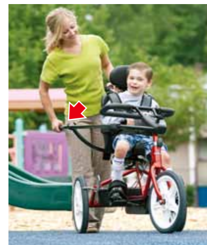
ステアリングバー 介助をする方が後方から走行の補助ができます。
