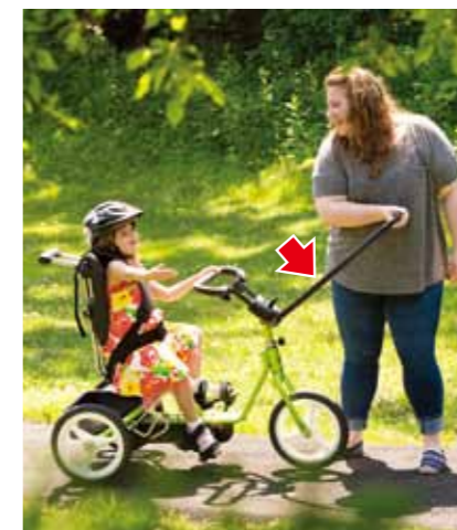
ガイドバー 介助をする方が前方から走行の補助ができます。
